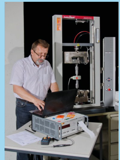
Kalibrierung einer Werkstoffprüfmaschine
